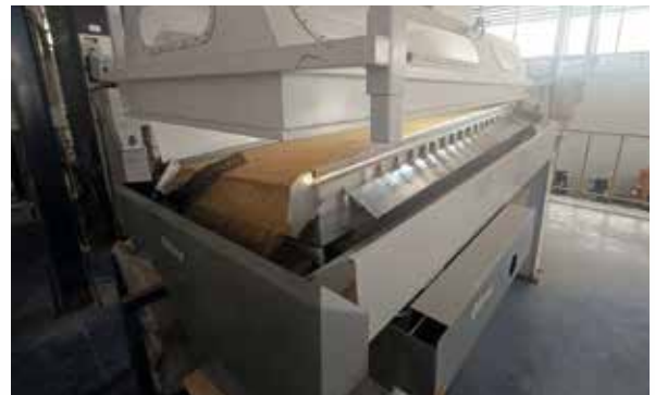
เครื่องคัดเมล็ดพันธุ์โดยอาศัยความถ่วงจำเพาะหรือเครื่องแกรวิตี้
